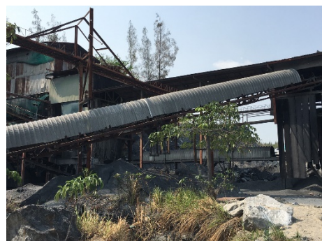
รูปที่ 2-12: การปิดคลุมสายพานลำเลียง
